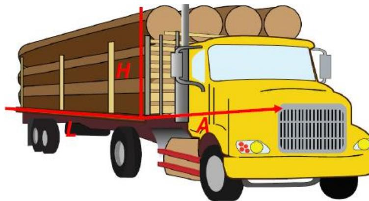
**Grafica No 1.** Obsérvese dimensiones de la carrocería a tomar en campo para la cubicación de la madera. Fuente: “*Guía para la Cubicación de Madera*” – CARDER, 2013.
